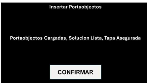
1. Abra la tapa para agregar los portaobjetos requeridos. Cierre y asegure la tapa. Seleccione el botón Confirmar para continuar con la fase de retención del protocolo durante el tiempo de retención seleccionado.
